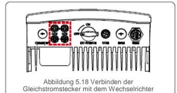
Abbildung 5.18 Verbinden der Gleichstromstecker mit dem Wechselrichter
