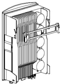
Abbildung 5.5 Installation des Wechselrichters
