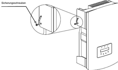
Abbildung 5.6 Fixierung des Wechselrichters
