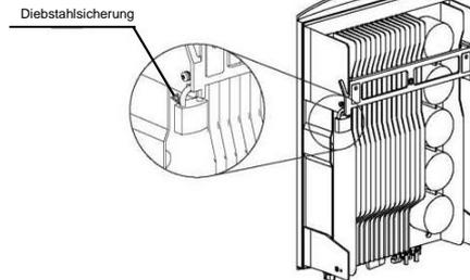
Abbildung 5.7 Montage des Sicherheitsschlosses
