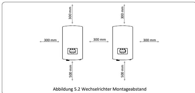
Abbildung 5.2 Wechselrichter Montageabstand
