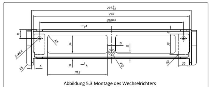
Abbildung 5.3 Montage des Wechselrichters
